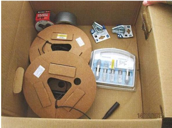
Digitalne sonde „Driver“ i optički kablovi
