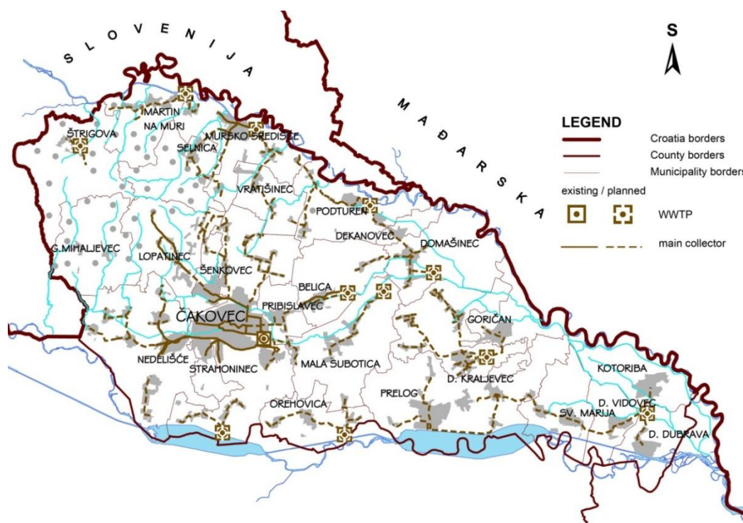
Slika 3 Stanje odvodnje i pročišćavanja u Međimurju prije provedbe projekata
