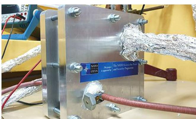
Prototip gorive čelije razvijen je u okviru NATO-ovog programa "Nauka za mir"
