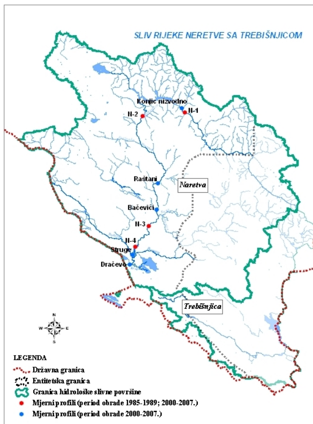
Slika 2.1.13.: Sliv rijeke Neretve i Trebišnjice sa mjernim profilima
