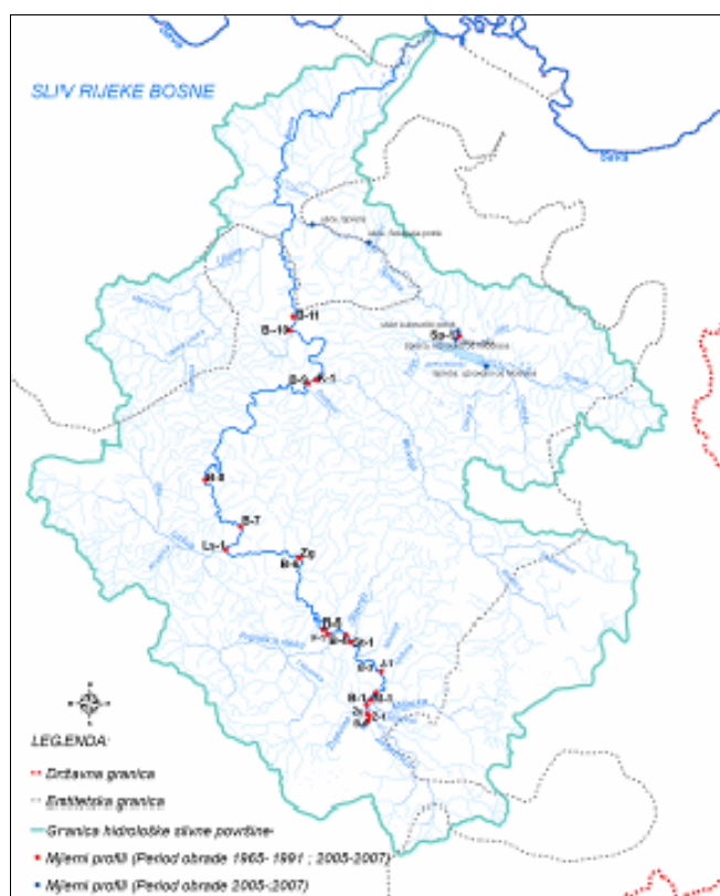
Slika 2.1.11.: Podsliv rijeke Bosne sa mjernim profilima
