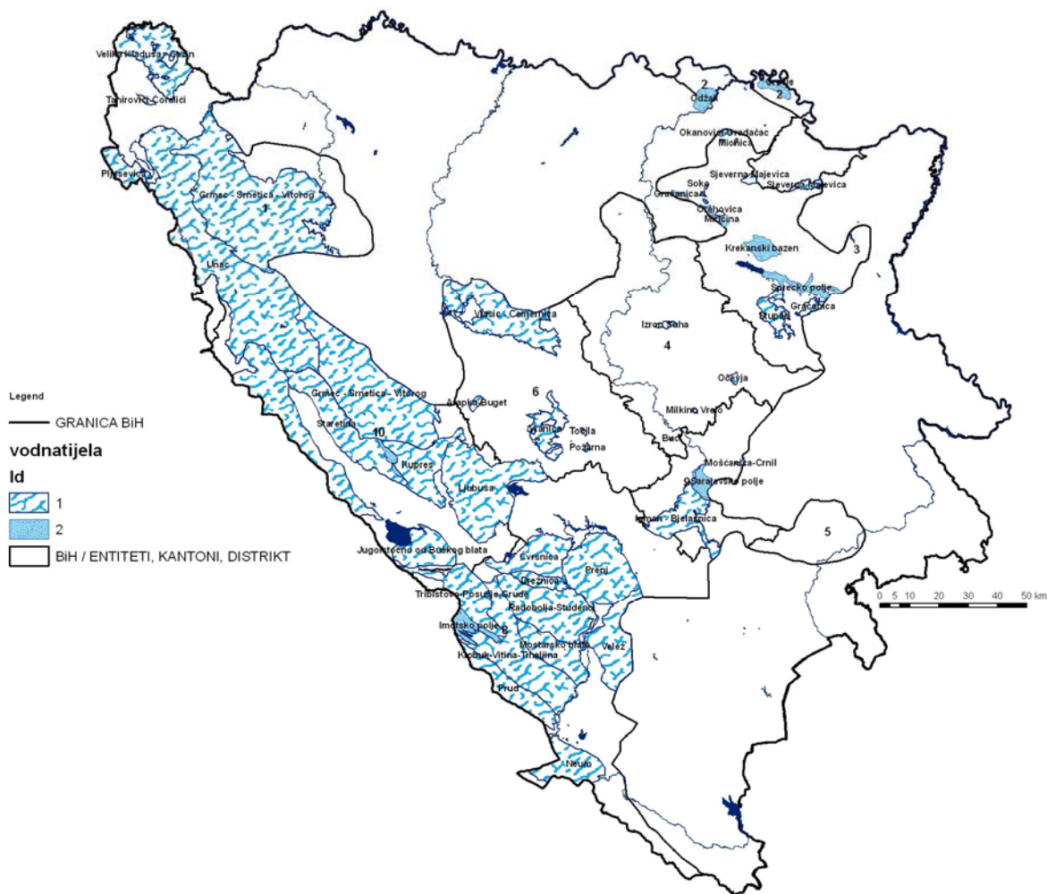
Slika 2.2.1: Prikaz vodnih tijela podzemnih voda na području Federacije Bosne i Hercegovine: 1. Vodna tijela u akviferima karstno-pukotinske poroznosti; 2. Vodna tijela u akviferima intergranularne poroznosti
