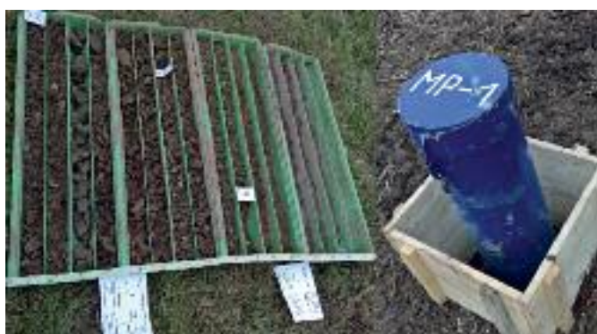
Slika 2. Prikaz nabušenog materijala u sanduku i finalni izgled pocinčani poklopac za pijezometar MP-1 u Maglaju
